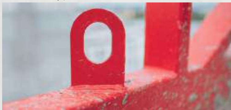
Mocowanie zawiesia dźwigu.
