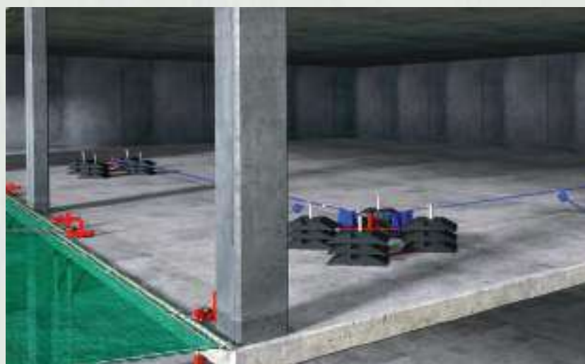
System asekuracyjny w postaci szeregowej z balastem wspólnym.
